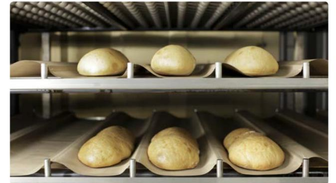
**4.** Die Rotosoleeinheit ist erhöht – und bringt das Brot in direkten Kontakt mit der heißen Aluminiumoberfläche.
